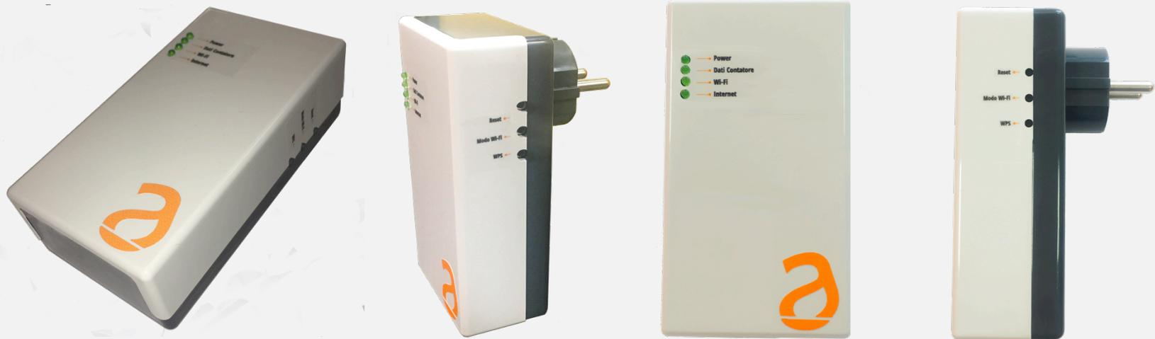
Dispositivo Plug connesso alla WIFI dell'utente con segnalazione acustica dell'avviso di distacco
