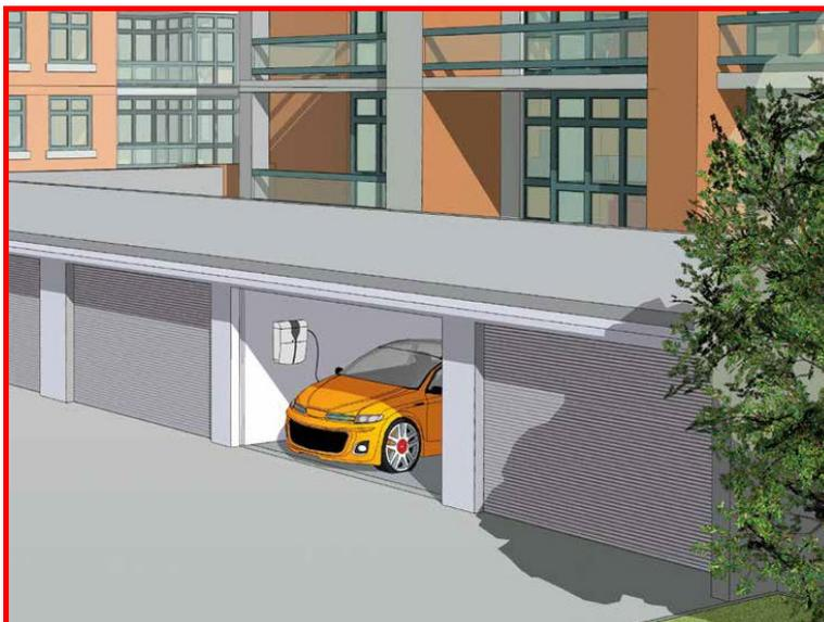
**Figura C.3.3 – Esempio di punto di ricarica singolo in un box auto privato**
