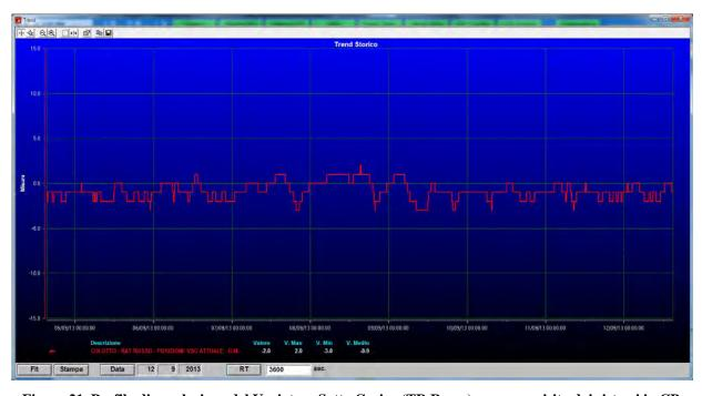
Figura 21. Profilo di regolazione del Variatore Sotto Carico (TR Rosso) come acquisito dai sistemi in CP.
